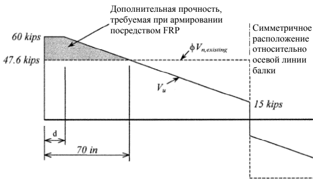
Рис. 14.2 Эпюра напряжений сдвига, показывающая зависимость существующей прочности от нагрузки. Армирование посредством FRP должно устранить нехватку прочности, показанную в виде затененной области.
