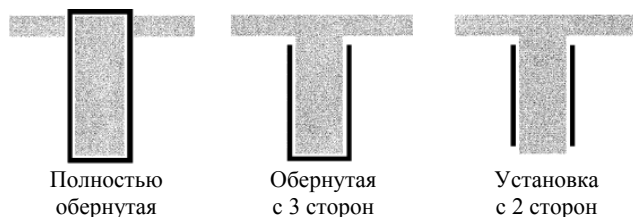
Рис. 10.1 – Типичные схемы обертывания для увеличения предела прочности на сдвиг с помощью ламинатов FRP.
