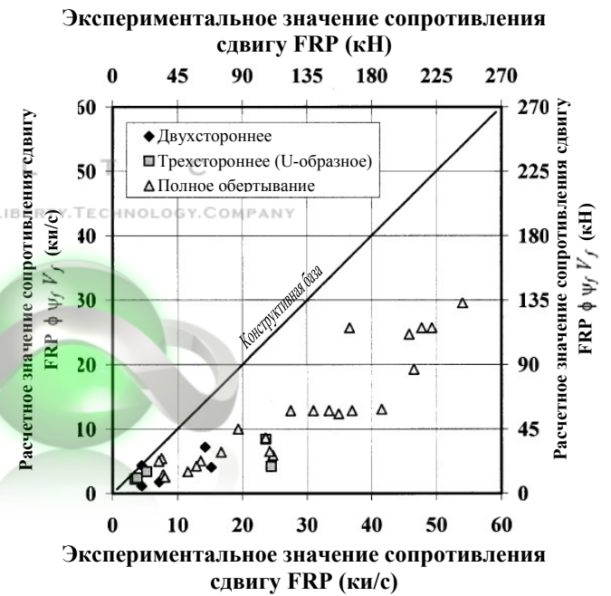
Рис. 10.3 – Сравнение экспериментальных результатов с результатами, полученными при использовании рассматриваемой методики проектирования.
